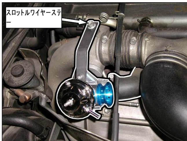
(7) ABV制御用バキュームチューブとブローオフバルブの6φユニオンをKIT6φホース<No.5>で配管して下さい。
