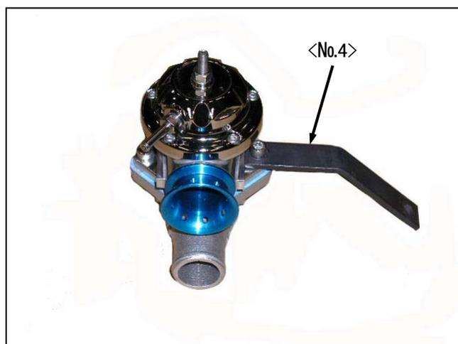
(5) ブローオフバルブ Assyを純正ホースバンドでABVリターンホースに配管して下さい。
